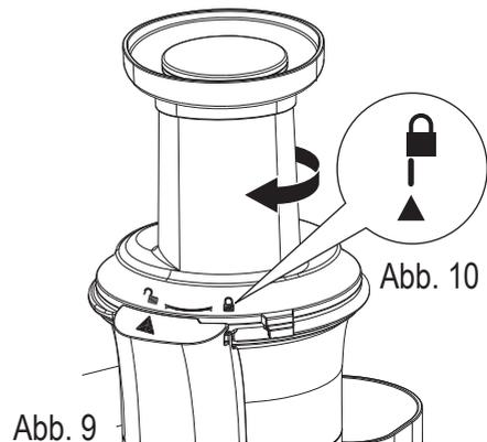
**Hinweis:** Sitzt der Einfülltrichter nicht in der korrekten Position, lässt sich das Gerät aufgrund des Sicherheitsschalters nicht einschalten.
